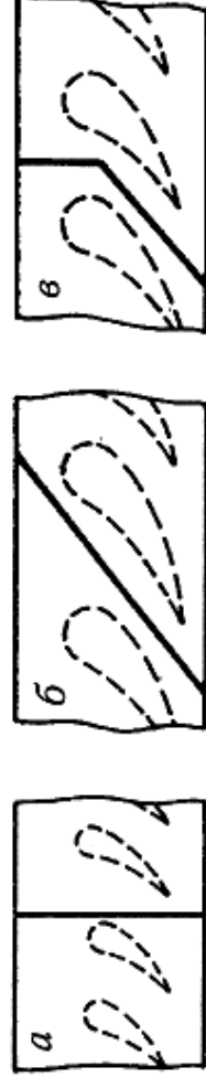
Рис. 2.29. Разъемы диафрагм: а – прямой разъем; б – косой, в – комбинированный
